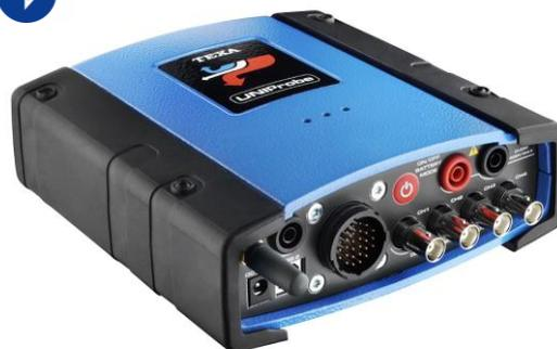
**UNIProbe** comprende ben **6 strumenti diversi all'interno dello stesso dispositivo**, tra i quali un **oscilloscopio a quattro canali** indipendenti in grado di effettuare misurazioni con sonde di tensione e pinze amperometriche in maniera precisa e professionale.
