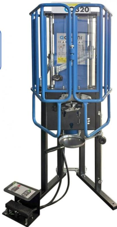
Specchio superiore regolabile per centraggio della calotta durante le operazioni di assemblaggio.
