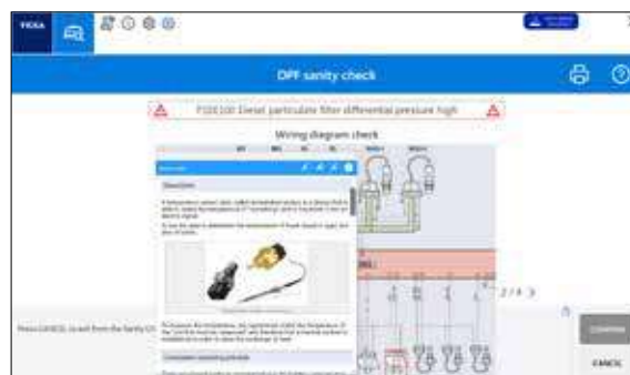
Ulteriori procedure diagnostiche per supportare la risoluzione dell'errore, come schemi elettrici, schede o altre informazioni utili.
